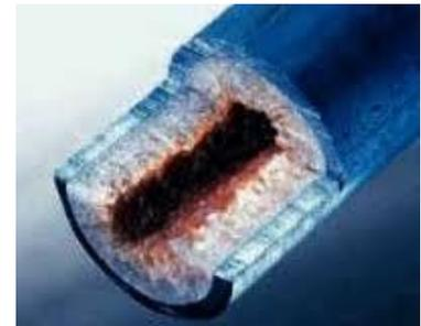
Korrosionsvorgänge können flächendeckend auf der gesamten Werkstoffoberfläche auftreten (Flächenabtragung) oder punktuell als Lochfraß. Während für den Flächenabtrag vornehmlich fehlende oder defekte Deckschichten verantwortlich sind, tritt Lochfraß in der Regel in Verbindung mit sogenannten Belüftungselementen ( hervorgerufen durch Feststoffpartikel ), einem starken Anionengehalt und mikrobiologischem Wachstum auf.
