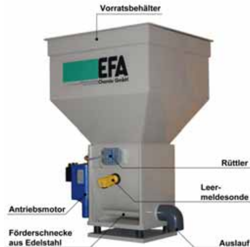
Abb. 3: Trockengutdosierer zur Dosierung von Efapur
